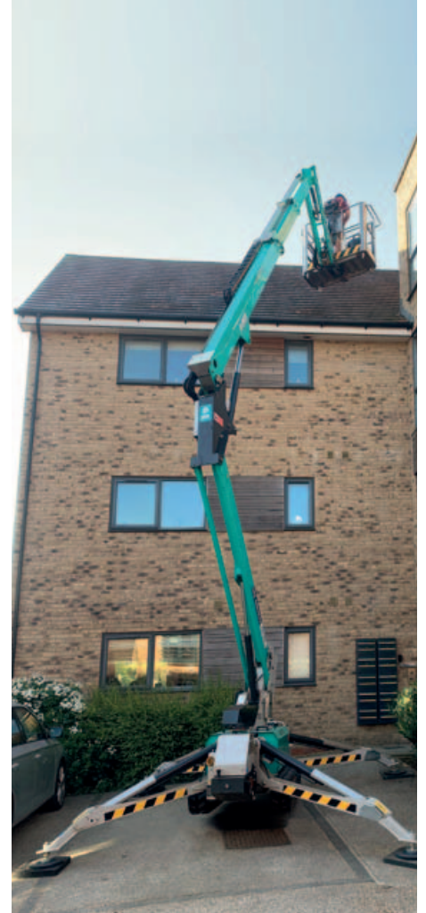
El brazo articulado con jib activo y la rotación de la cesta \pm 62^\circ , junto con el giro de la torreta 360^\circ (no continuo), permiten el posicionamiento óptimo de la máquina en cualquier situación de trabajo.
