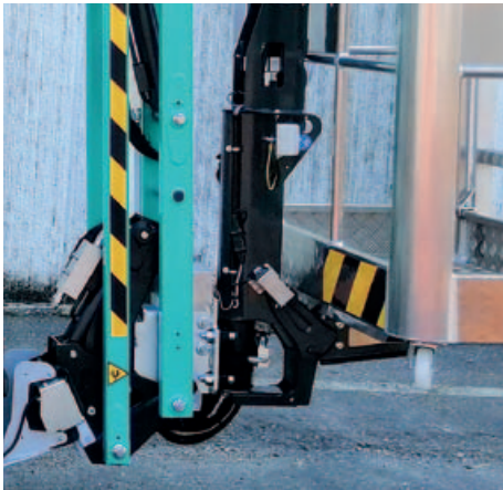
Grupo jib compacto con alojamiento para la cédula de carga y rotación de la cesta.
