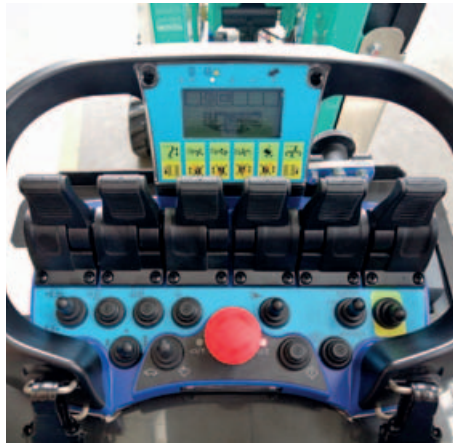
Panel de control simple e intuitivo con sistema de soporte externo para la cesta. Más espacio para el operador dentro de la cesta.
